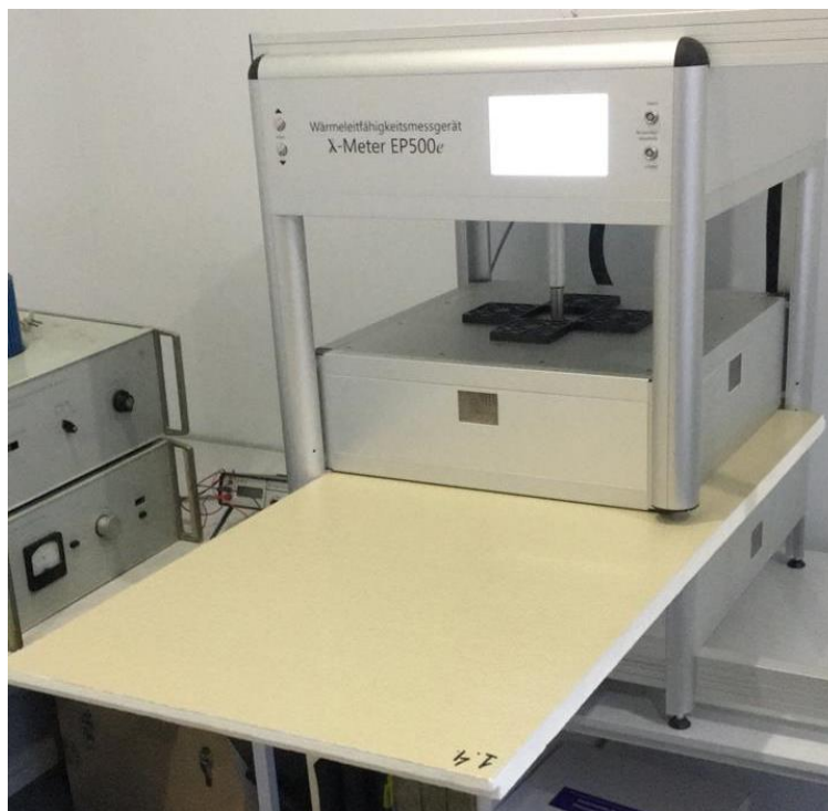
Рис. 2 Процесс измерения теплопроводности плиты из пенополиизоцианурата LOGICPIR PROF Ф/Ф на приборе Lambda-Meter EP500e
