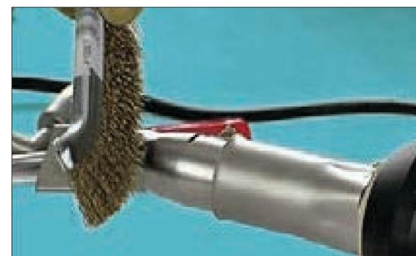
Нагар с сопла по мере его накопления удаляйте с помощью медной металлической щетки.
