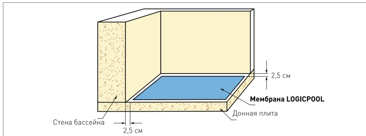
При раскрое ПВХ мембраны необходимо предусмотреть, чтобы сварные швы не проходили в местах установки встраиваемых элементов, так как это может затруднить монтаж прижимных фланцев (монтировать сварные швы необходимо на расстоянии не менее 250–300 мм от встраиваемых элементов).
