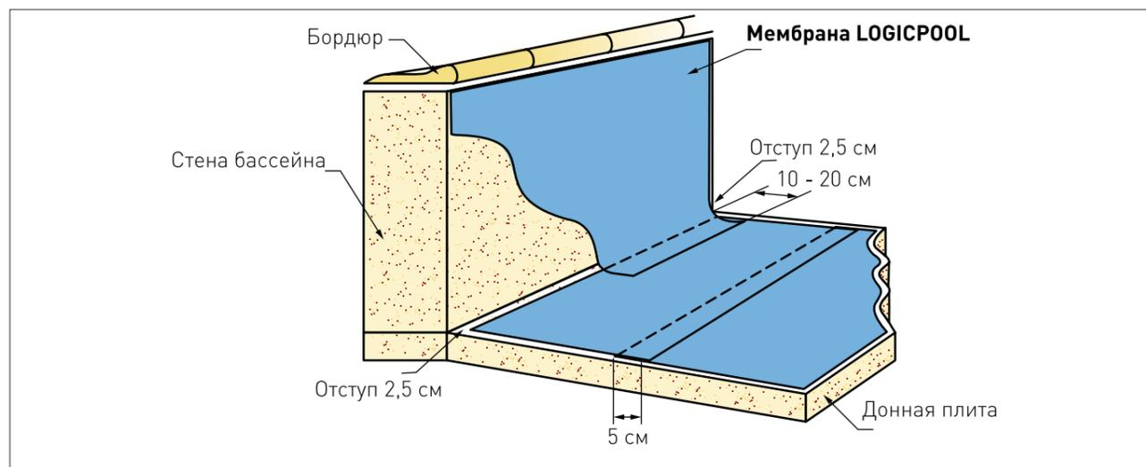
Важным этапом процесса соединения покрытий стен и дна является выполнение внутренних углов. Наиболее эстетичным и надежным способом выполнения внутреннего угла в плавательном бассейне является «конверт».
