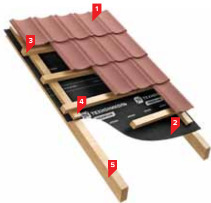
Рис. 5. Строение кровельной системы TH-ЛЮКСАРД Классик
